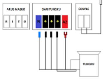
**CARA PEMASANGAN KABEL DAN SETING THERMOCONTROL
